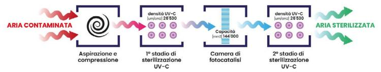
Il SaniAir garantisce una rapida sanificazione e circolazione dell'aria sanificata attraverso un processo specifico:
